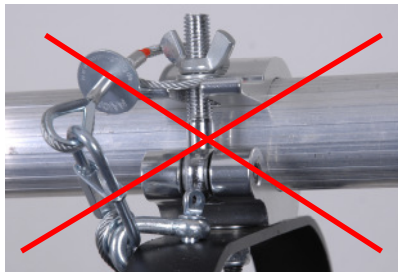
Bild 5: Schlaufe nicht an Ringmutter verhaken
