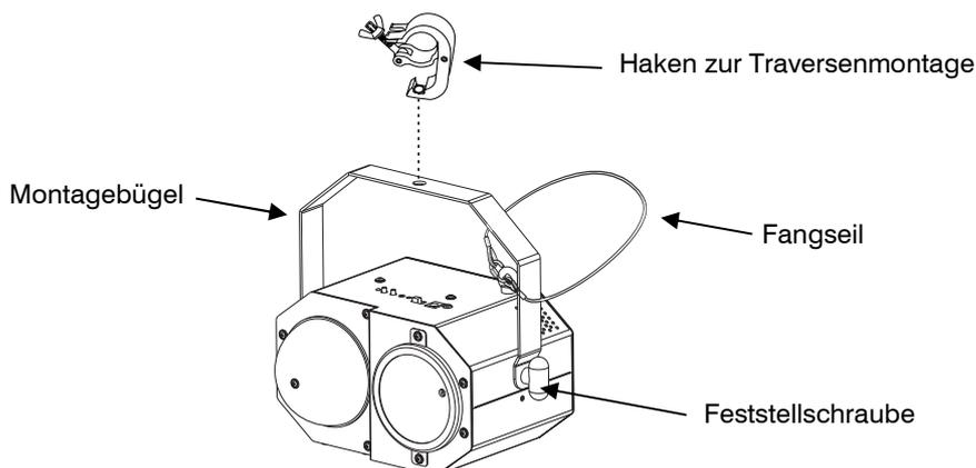
Das Gerät ist zur Überkopfmontage über den Montagebügel vorgesehen. Montieren Sie es über den Bügel an einer Wand oder einer Decke. Alternativ kann es auch mit geeigneten Haken über den Bügel an einer Traverse befestigt werden. Zum Ausrichten lösen Sie die Feststellschrauben am Hängebügel, stellen die gewünschte Neigung ein und ziehen die Schrauben wieder fest an.
