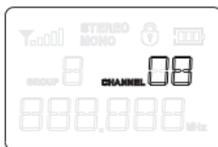
Wählen Sie mit der Taste **▲** oder **▼** den neuen Kanal (1-6). Die für diesen Kanal voreingestellte Frequenz wird darunter angezeigt. Bestätigen Sie mit **SET**. Der nachfolgende Menüpunkt angewählt. Nach 5 Sekunden wird der Einstellvorgang auch automatisch beendet.
