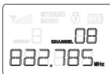
Wählen Sie mit der Taste **▲** oder **▼** die neue Gruppe (0-9) und bestätigen Sie mit **SET**. Im Display blinkt jetzt „**CHANNEL**“ und der aktuelle Kanal.
